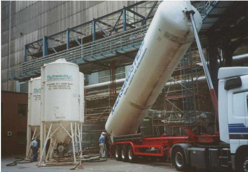
**Abbildung 7:** Entleerung eines Silo-Lkw mit Tiermehl
