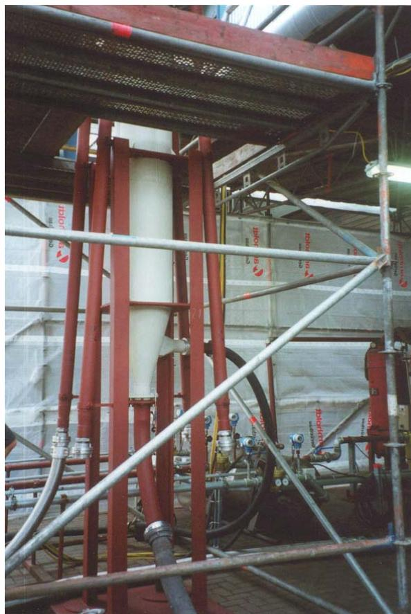
**Abbildung 8:** 4-fach-Verteiler hinter Silo-Lkw
