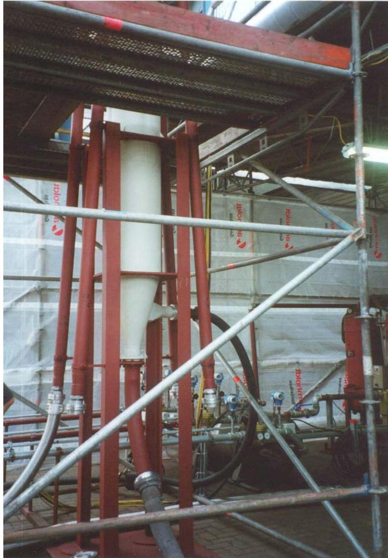
**Abbildung 13:** Fotos des Verteilers mit Anschlüssen für Einzelleitungen und Zusatzluft
